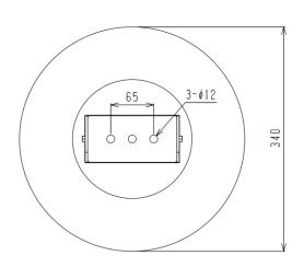
(仕 様) •重量 3.4 kg (本体) •定格電圧 AC400 V ▪周波数 50/60 Hz ・消費電力 150 W •全光束 22,000 lm
